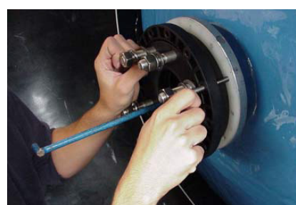
6: Utilisez la bride d'adaptation pour rattacher le système de distribution à la bride 6". Puis enlevez l'extension.
