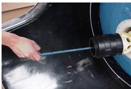
2: Les pièces sont assemblées (à l'extérieur de la bouteille) et introduites en utilisant l'extension I-WR03-LA
